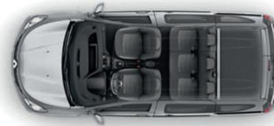
Caja semividriada / Transporte de pasajeros en la segunda fila de asientos / Funcionalidad 1/3 - 2/3 del respaldo trasero, volumen de carga hasta 3000 dm<sup>3</sup> / Asiento trasero rebatible, largo de carga hasta 1570 mm
